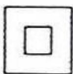
**Doppio isolamento.** Il prodotto elettrico che riporta questo simbolo in targa rappresenta un'apparecchiatura che può, anzi deve funzionare senza collegamento a terra, in quanto intrinsecamente sicura sotto il profilo della protezione contro la scossa elettrica provocata da cedimenti dell'isolamento principale.
